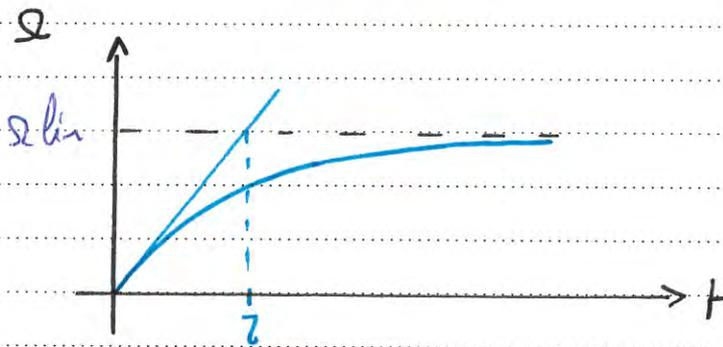
La vitesse limite  $\Omega_{\text{lim}}$  dépend de la charge  $\Gamma_n$ .
