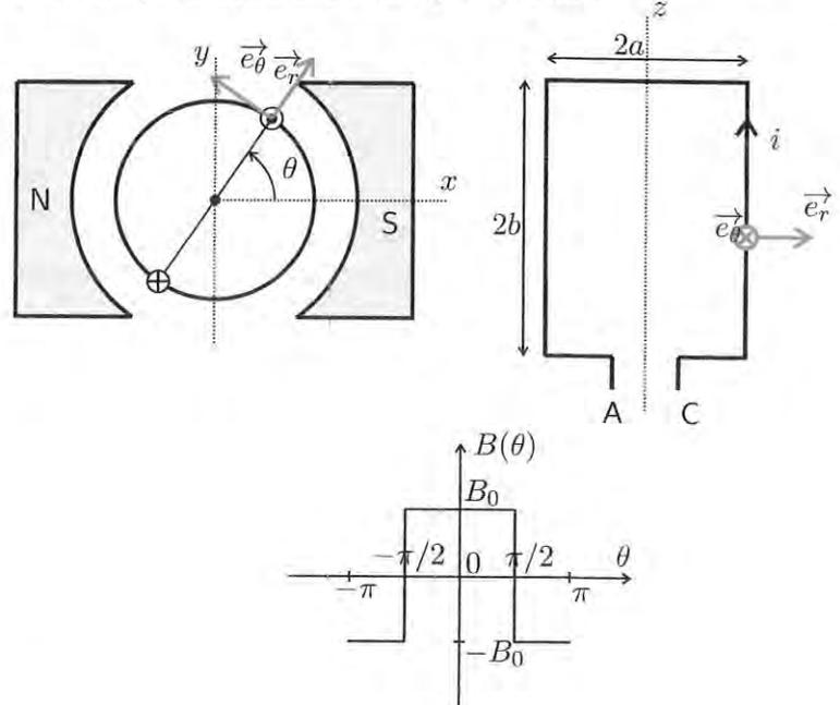
Lors de la rotation la spire est soumise à un couple de frottement fluide dont le moment est du type  $\vec{\Gamma}_f = -\beta \vec{\Omega}$  où  $\beta$  est une constante positive.
